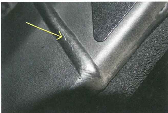
Bild 4: Als besonders schwierig stellt sich das Auffinden von so genannten Feinst- bzw. Haarrissen dar ...
