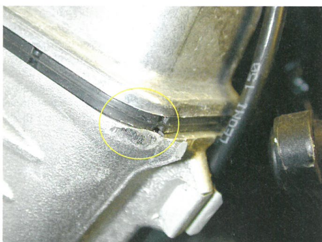
Bild 14: ... ein eingeschlagener Zylinderkopf.
