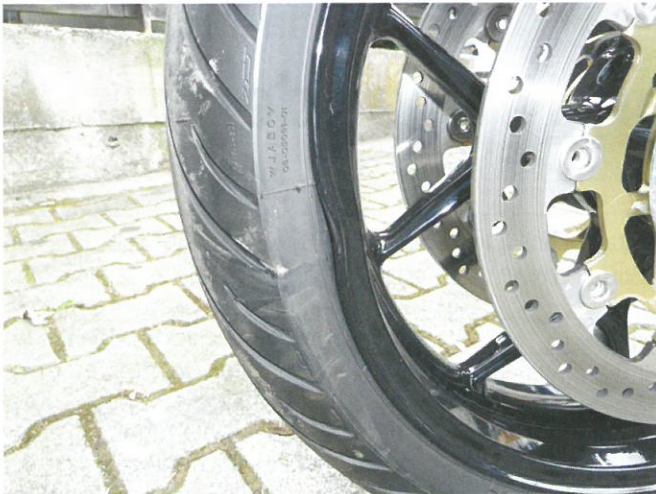
Bild 2: Eine leichte Eindellung der Vorderradfelge ...
