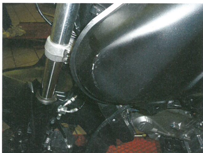
Bild 12: ... versteckt sich auch schon mal ein eingedellter Kraftstoffbehälter.
