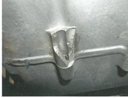
Bild 16: Oder ein gebrochenes Motorgehäuse.
