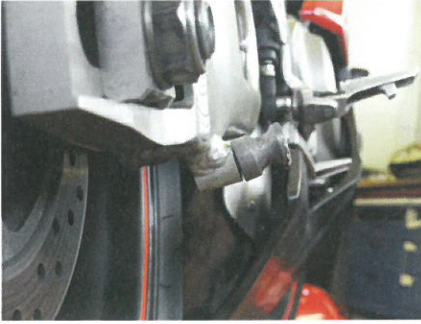
Bild 15: Auch lohnt es sich mal, unter das Krad zu schauen (verformte Montageheberaufnahme).
